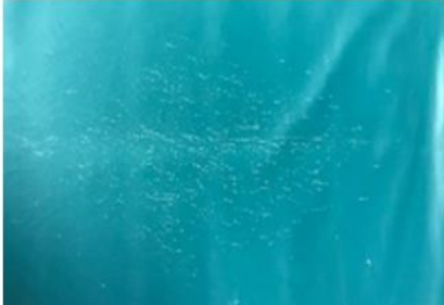
Fissures présentes à la surface d'une housse
